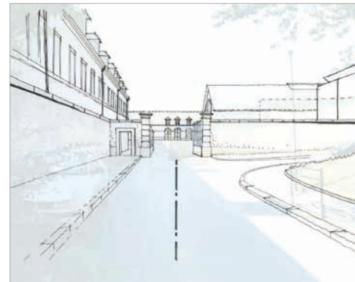
DAME SEGAUDE : Reprise du dessin de l'ouverture du portail et des piliers dans l'axe de la rue avec trottoir et passage piéton côté gauche. Suppression d'un redent de mur. Recherche de perspective et de profondeur vers la place d'Armes.
