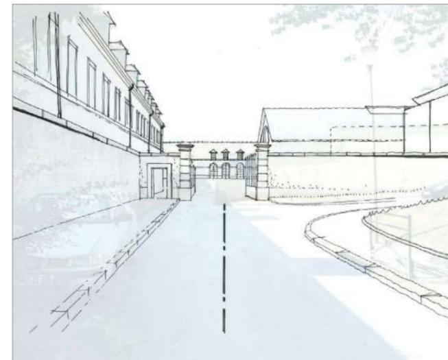
DAME SEGAUDE : Reprise du dessin de l'ouverture du portail et des piliers dans l'axe de la rue avec trottoir et passage piéton côté gauche. Suppression d'un redent de mur. Recherche de perspective et de profondeur vers la place d'Armes.
